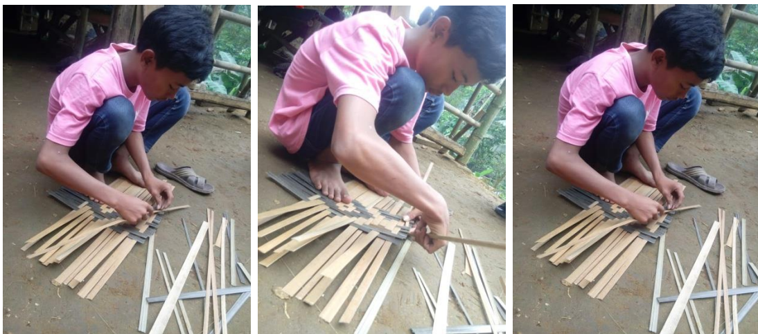
Gambar 2.3 Proses uji coba pembuatan dan pengembangan anyaman bilik motif dalam ukuran yang lebih kecil dengan menggunakan kulit bambu
