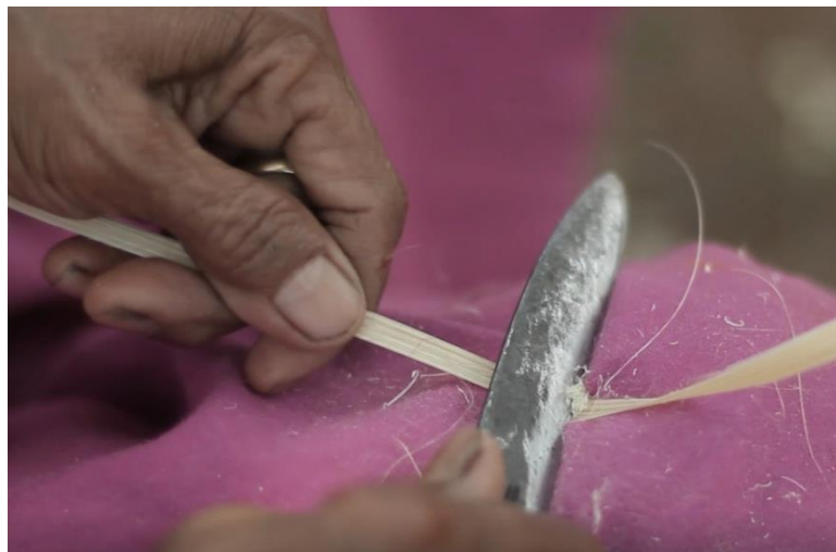
Gambar 2.1. Proses penyerutan bilah bambu dilakukan sebelum proses penjemuran untuk mendapatkan ketebalan dan kelenturan bilah bambu saat dianyam.
