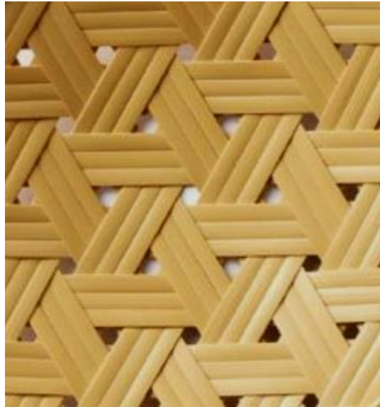
Gambar 2.5 Hasil pengembangan motif anyaman bambu kuno (gambar kanan) dengan menambahkan jumlah bilah bambu (dari 1 bilah menjadi 3 bilah dalam setiap anyaman)
