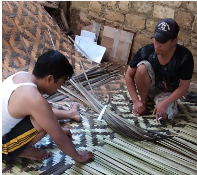
Gambar 2.2 Proses pembuatan lembaran anyaman bilik motif yang dibuat dalam ukuran besar (3 meter x 2 meter).
