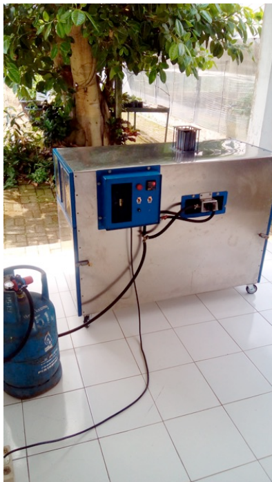
Gambar 2. Mesin pengering Produk Softcandy Pepaya Callina IPB dan Oven untuk Analisis Kadar Air
