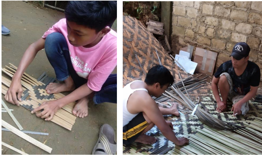
Gambar 4.1. Proses pembuatan motif kembangan dengan jenis anyaman tunggal
