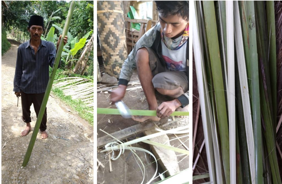
Gambar 4.5. Proses pembuatan bilah kirei dari tanaman palem sagu
