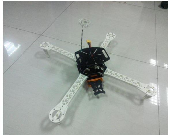
Gambar 4.3. (a) dan (b). Kerangka Tampak atas dan Bawah Wahana
