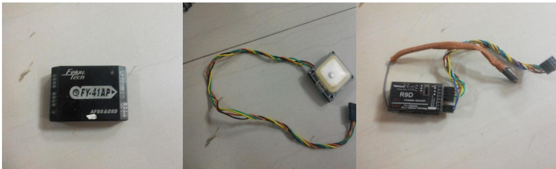
Gambar 4.5. (a) Flight controller, (b) Kompas untuk menunjang GPS, (c) Receiver yang digunakan di Wahana
