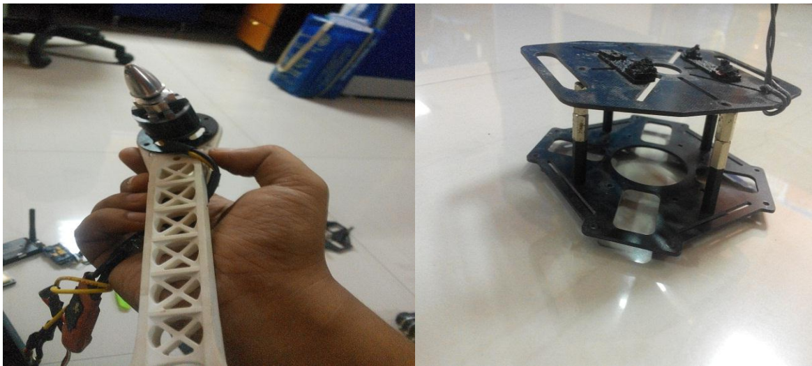
(a) (b) Gambar 13. (a) Lengan penahan motor. (b) Kerangka Penghubung lengan Wahana
