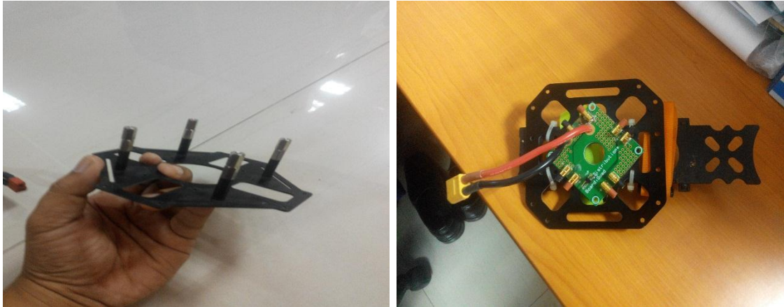
(a) (b) Gambar 4.1. (a) Dudukan bawah Kerangka Penghubung lengan Wahana. (b) Dudukan Distribution Board
