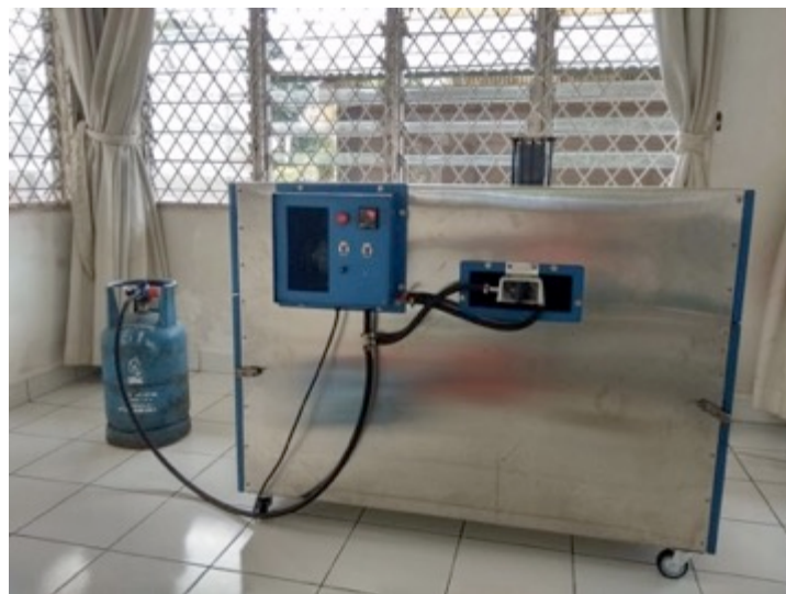
Gambar 3. Peralatan/Mesin Pencuci Otomatis dan Pengering Tunnel
