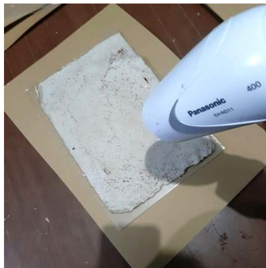
Gambar 4.12 Proses pengeringan dengan hair dryer . (sumber: dokumentasi peneliti)
