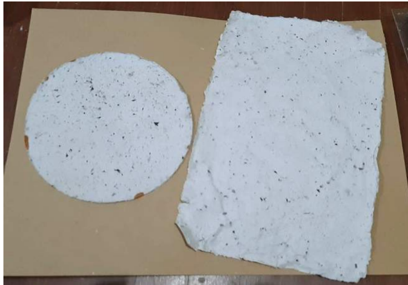
Gambar 4.11 Hasil cetakan kertas daur ulang dengan dua Penyaring/pencetak yang berbentuk persegi empat dan lingkaran. (sumber: dokumentasi peneliti)
