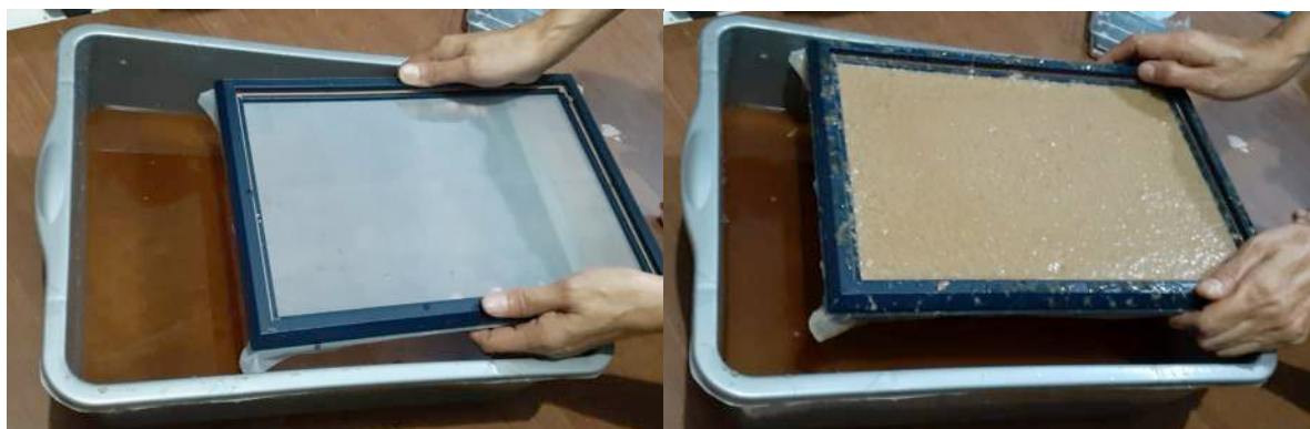
Gambar 4.10 Proses pencetakan kertas daur ulang. (sumber: dokumentasi peneliti)
