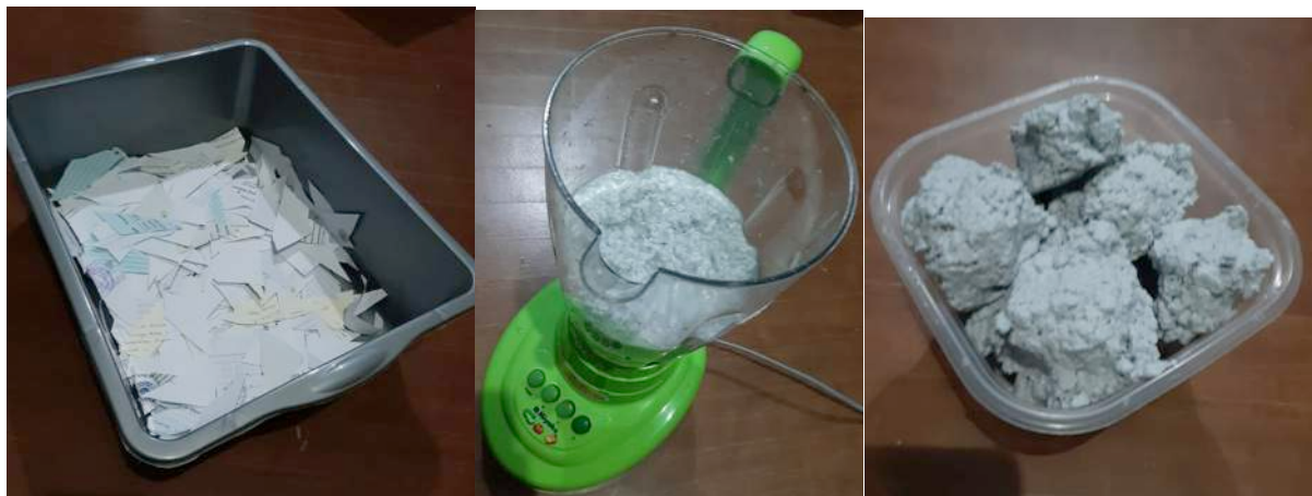
Gambar 4.6 Proses pembuatan bubur kertas (dari atas kiri ke bawah) (sumber: dokumentasi peneliti)
